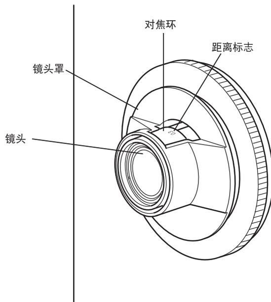
在将主体和镜头组合的状态下进行校正。请将相同编号组合使用。
