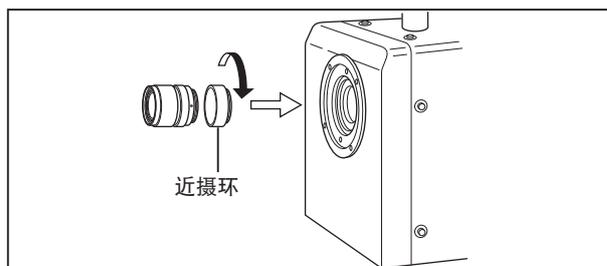
**3. 将镜头罩的两根销子与主体的两个孔对齐后插入，使镜头罩覆盖住镜头，将镜头罩的螺丝部分沿顺时针旋转。**
