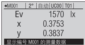
显示 < MEAS > 屏幕，同时还会显示最新的测量数据。或显示所选保存数据的屏幕，同时显示已保存的测量数据。
