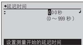
选择了“单次测量”“平均测量”时,显示 < 延迟时间 > 屏幕。选择了“连续测量”时,设置内容得到确定并返回 < 菜单 > 屏幕。
