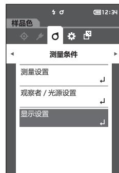
2 使用 [▲] [▼] 键，将光标移至“显示设置”，按下 [确定] 键。
