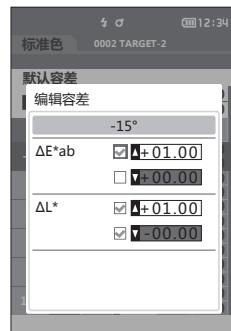
4 完成所有项的设置后，使用 [ ▲ ] [ ▼ ] 键，将光标移至“确定”，按下 [ 确定 ] 键。
