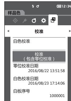
2 使用 [▲] [▼] 键，将光标移至“校准（包含零位校准）”，然后按下 [确定] 键。
