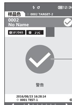
在打印输出时打印“WARN”，将在接近容差的数值后也附加“w”。
