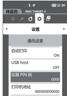
**4 PIN编号的数字上下两侧显示▲▼。使用 [▲] [▼] 键指定数值。要在数值间移动光标时，使用 [◀] [▶] 键。**
