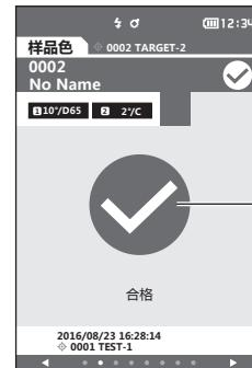
在打印输出时打印“PASS”。
