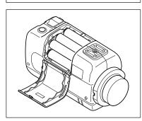
4 将电池仓盖上的突起对准本仪器电池仓的 孔插入,直至电池仓盖响起"咔哒"一声。
