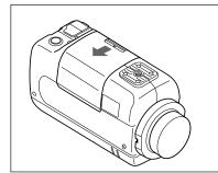
② 朝着箭头▼尖端方向向上推动,以滑动本 仪器侧面的电池仓盖,使其打开。
