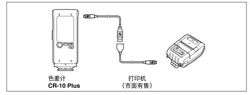
打开连接器保护罩,将 USB 电缆的 Micro A 连接器连接到本仪器的 USB 接口。
